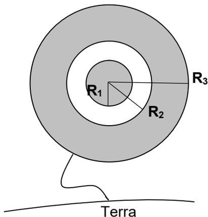
Capacità del condensatore sferico:  $C_{1,2} = 4\pi\epsilon_0 (R_1 R_2)/(R_2 - R_1) \cong \epsilon_0 S/\delta$
